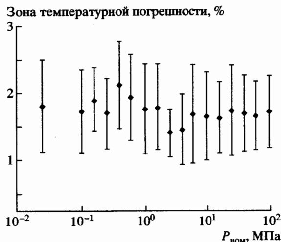
Рис. 25. Среднее значение и дисперсия зоны суммарной температурной погрешности датчиков МИДА-ДИ-13П в интервале температур -40 \dots +80^\circ\text{C} для разных диапазонов измерения.
