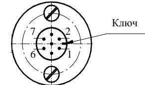
Рисунок 13 – цоколевка разъемов РСГ4ТВ и РСГ7ТВ
