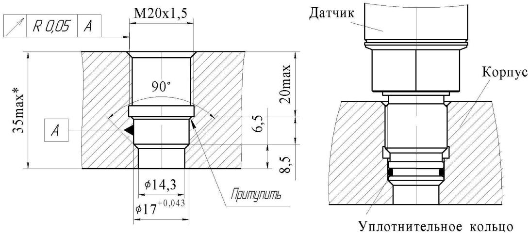
**Рисунок 6 – Разметка монтажного гнезда и установка датчика МИДА-ДИ-12П-072-К**
