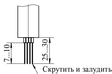
Подключение, заделка кабеля
