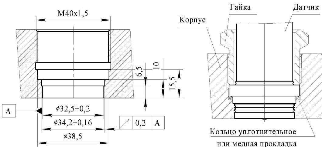
**Рисунок 5 –Разметка монтажного гнезда
