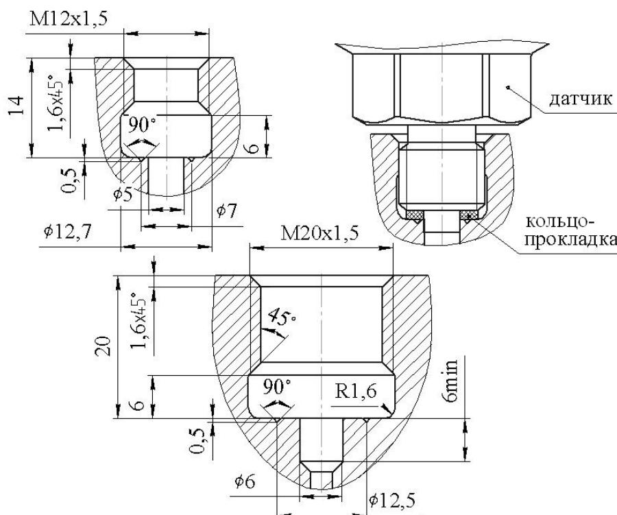
**Рисунок 4 - Разметка монтажного гнезда и установка датчиков
