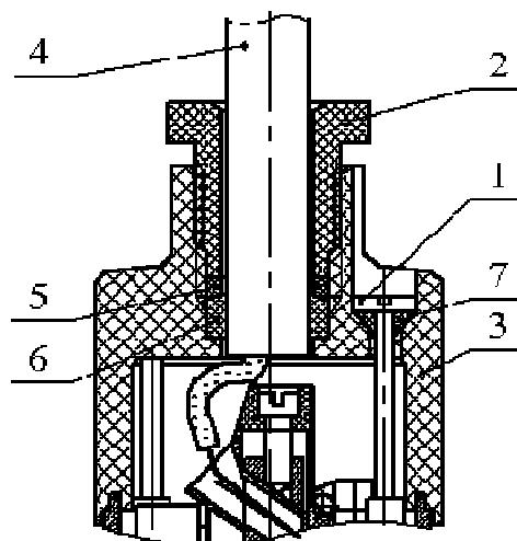
**Рисунок Е1 - Сальниковый узел датчиков МИДА-ДИ-12П(-Ex)-К**
